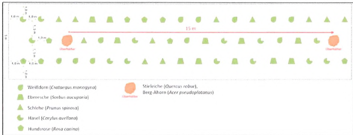
Abbildung 12 Pflanzschema einer dreireihigen Feldhecke mit Überhältern aller 15 m (abgewandelt von einem Schema der uNB Kreis Lippe)
